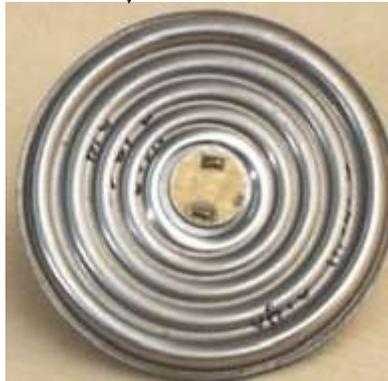
La capsule anéroïde est **soumise extérieurement à la pression** régnant à l'altitude de vol (via les prises de pression statique) et **se déforme en conséquence**.
