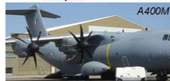
**Augmenter le nombre de pales** permet de **réduire l'encombrement** de l'hélice et la vitesse en bout de pale à puissance égale.
