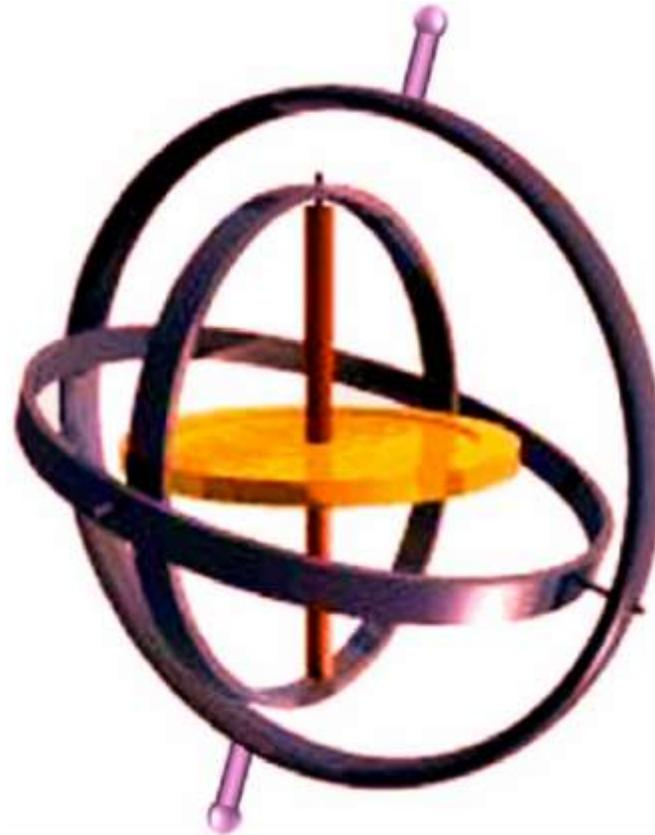
Si aucune force n'est appliquée perpendiculairement à l'axe de rotation d'un gyroscope, celui-ci **conservera son orientation par rapport à l'espace absolu** : orientation **fixe par rapport aux étoiles**, indépendamment de la rotation de la terre.
