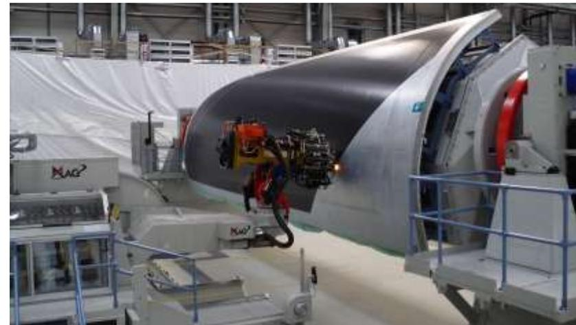
Nappage d'un panneau de fuselage A350XWB à l'aide d'une machine de placement de fibre à commande numérique
