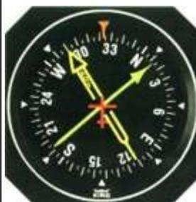
La **rose des caps** est automatiquement orientée en fonction du cap magnétique suivi.
