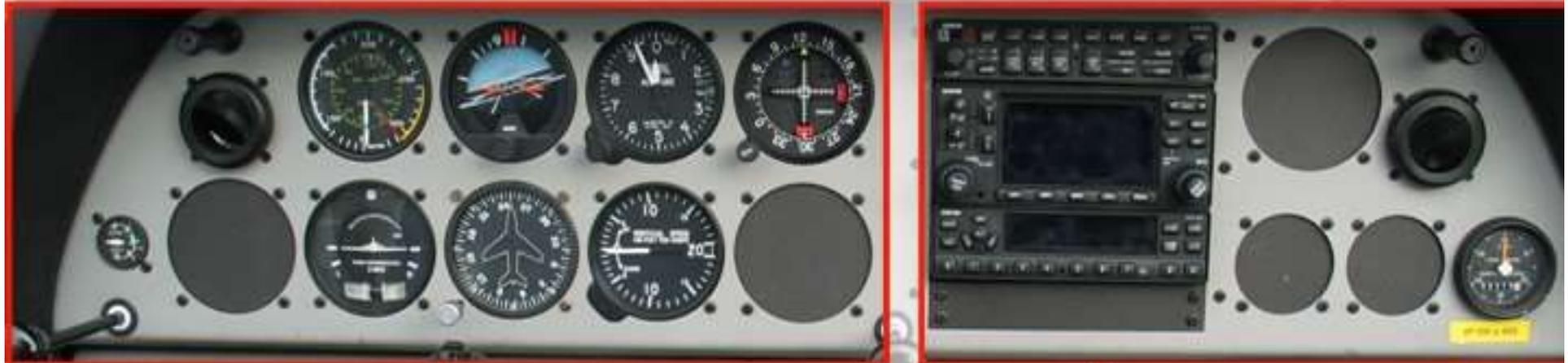
La partie gauche du tableau central regroupe les **instruments de pilotage** et de navigation.
