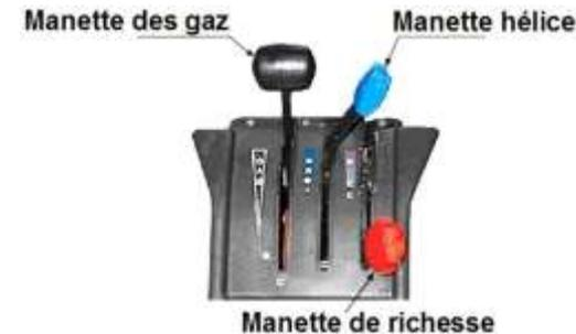
Le système **compare**, en permanence, la **vitesse de rotation** de l'hélice avec la **consigne** donnée par le pilote.
