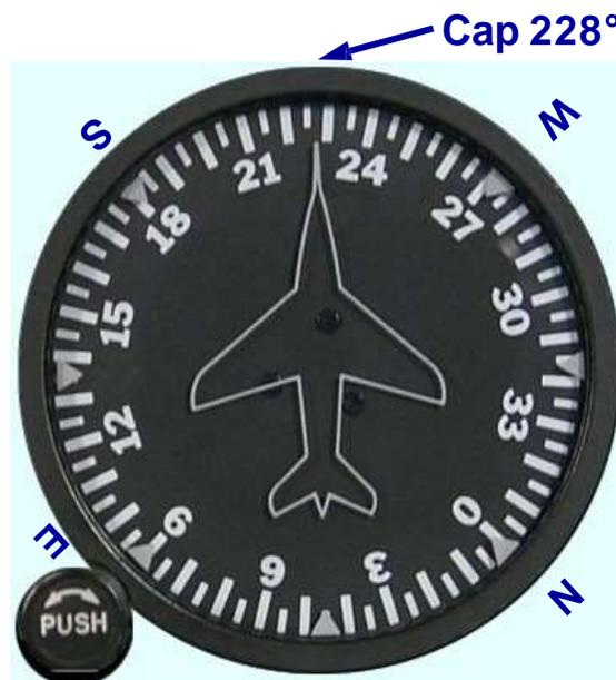
Ensuite, la **stabilité du gyroscope** permettra un **affichage stable et précis du cap**, quelles que soient les évolutions de l'aéronef.
