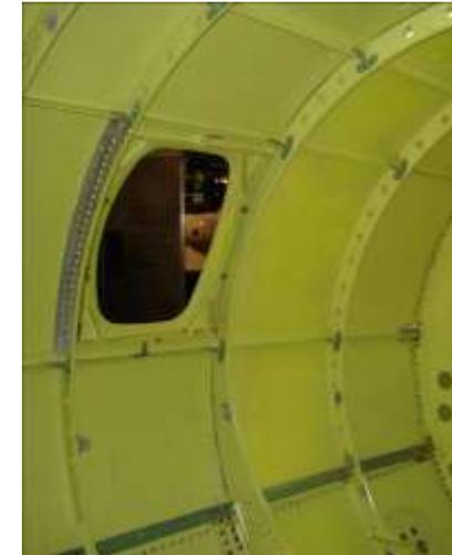
La mise en œuvre et l'usinage des profils et tôles peut se faire à grande échelle donc avec des coûts moindres d'où le développement de ce type de construction.
