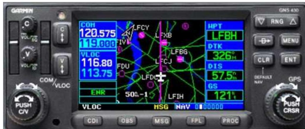
Le pilote peut définir et afficher le tracé de la **route à suivre**. Les données de navigation sont affichées (*orientation de la route à suivre, vitesse, distance et temps de parcours pour chaque segment de la navigation, heure estimée d'arrivée, etc...*).
