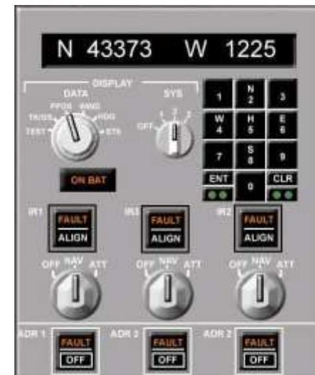
Exemple de panneau de commande des centrales inertielles d'un avion de ligne
