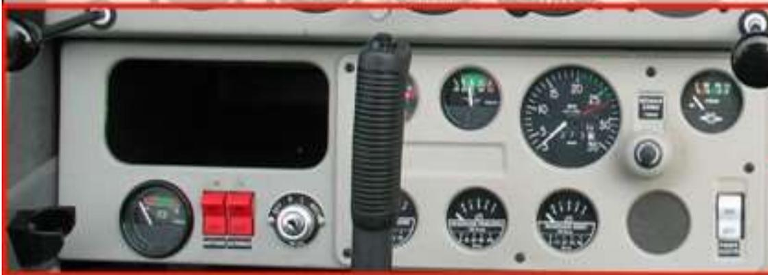
La partie basse du tableau de bord regroupe les instruments et commandes relatives au **fonctionnement du moteur** et des circuits qui lui sont associés.
